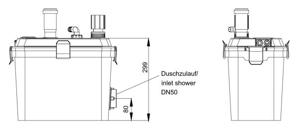
Zulauf kann beidseitig verbaut werden/ Inlet can be mounted on the left or right side
