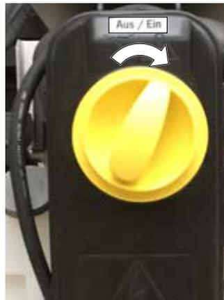
1. Drehschalter der Pumpen auf Position „EIN“
