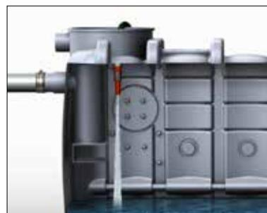
Beispiel: Befüllung mit Wasserschlauch über Revisionsöffnung
